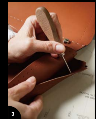
3 구멍 내기. 작은 구멍은 홀 펀처를 이용해 수직안하고, 백 가장자리에 적용하는 구멍은 대개 망치를 사용한다.
